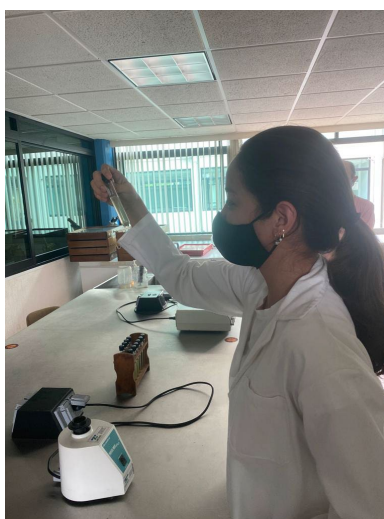
Figura 2. Agitación de las microalgas para suspenderlas previo a la lectura de fluorescencia. Sobre la mesa de trabajo se aprecian en orden: el equipo Maxi Mix Plus, la gradilla con los tubos de cultivo y al fondo, el
