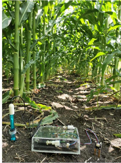
Figura 9. Nodo sensor implementado en un cultivo de maíz.
