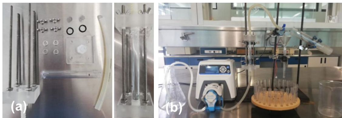
Figura 4. (a) Fotografía de las partes que componen a la columna acrílica de adsorción, desarmada (izquierda) y armada (derecha). (b) Fotografía del diseño experimental construido y ensamblado utilizado para los estudios de adsorción en flujo continuo.
