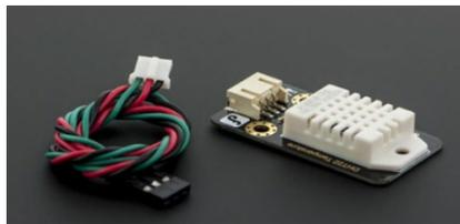
Figura 5. Sensor de temperatura y humedad DHT22
